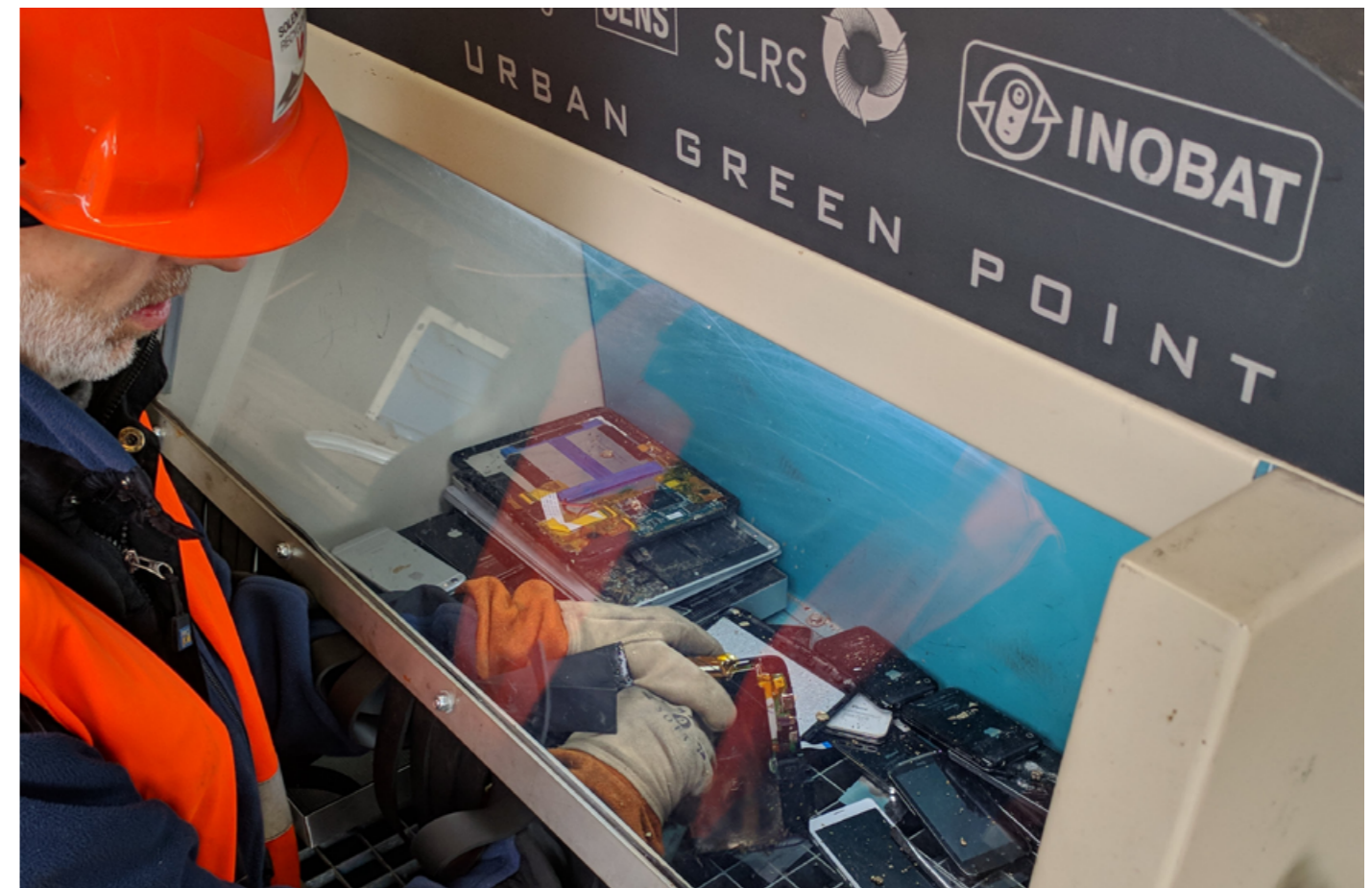
Batteries au lithium lors du démontage. (Photo: Solenthaler Recycling)
