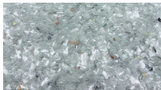
Die Glasfraktion, die dem Grossteil der Outputmasse entspricht, kann zu fast 100 % stofflich verwertet werden.
