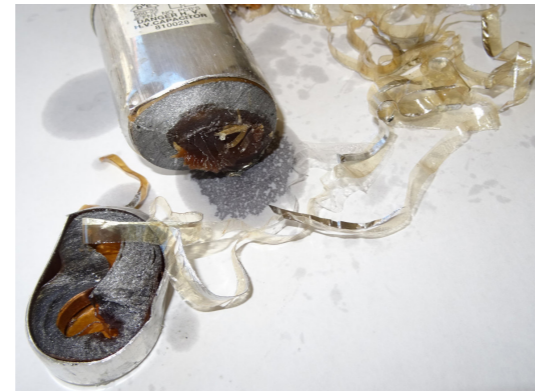
Wie die Zerlegung zeigt, handelt es sich beim Mikrowellen-Kondensator um einen stark imprägnierten Kondensator.
