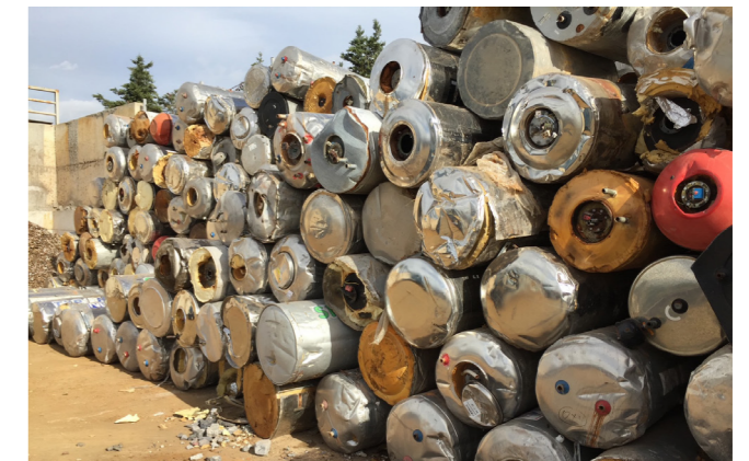
Abbildung 4: Boiler zur manuellen Abschälung und Verarbeitung der PU-Schäume in Kühlgeräterecyclinganlagen (Bildabdruck mit freundlicher Genehmigung der RAL-Gütegemeinschaft Rückproduktion von Kühlgeräten e.V., 2020)
