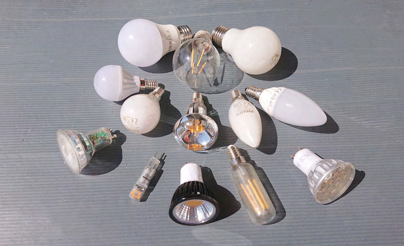
Photo 1: LED non rectilignes en 13 combinaisons de matériaux différentes
