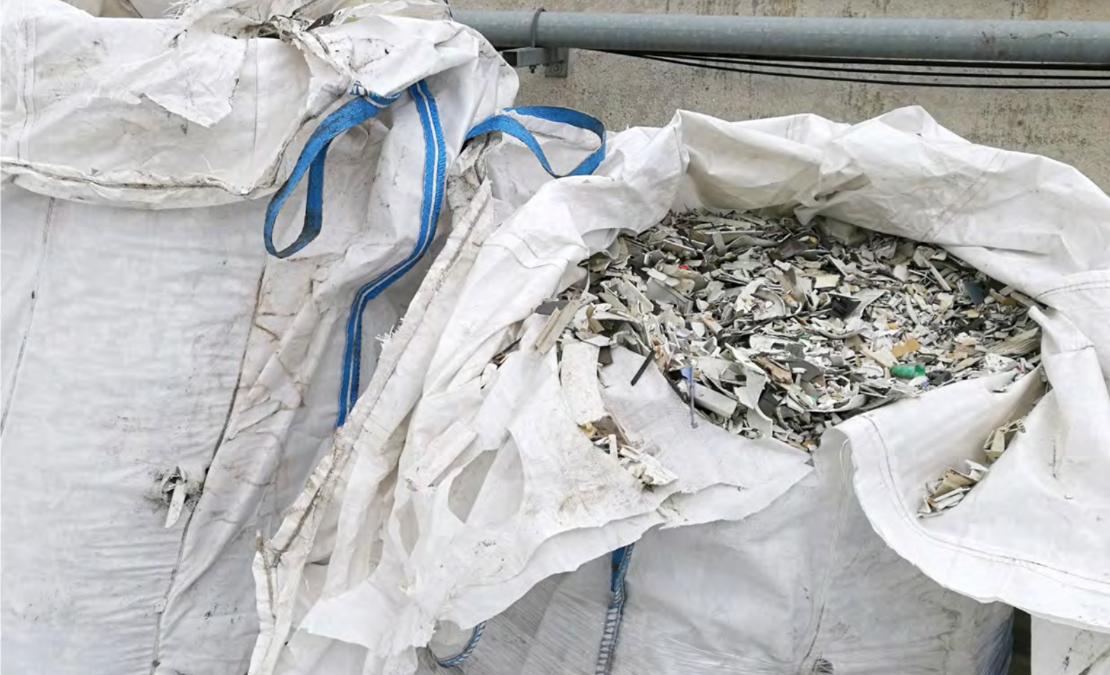
Photo 1: Fraction de matières plastiques provenant du traitement de gros électroménager.
