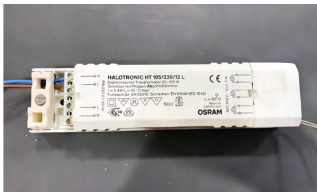
Photo 3: Ballast électronique (non soupçonné de contenir des PCB).
