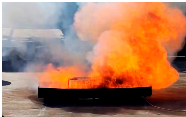
Photo 3: Phase 2 – La batterie est en feu et dégage une vague de chaleur intense.
